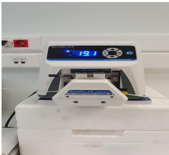
Σχήμα 6. 14: Σύστημα Περισταλτικής Αντλίας Στήλης, της εταιρείας Masterflex, μοντέλο 7519-85.
