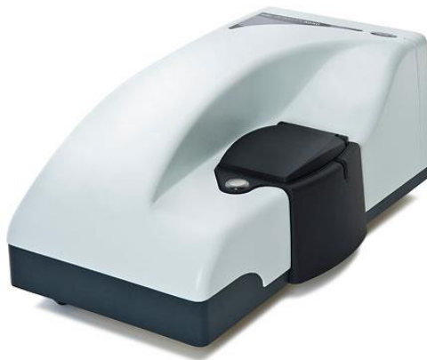
Σχήμα 6. 12: Μηχάνημα ZetaSizer, της εταιρείας Malvern Panalytical, United Kingdom.
