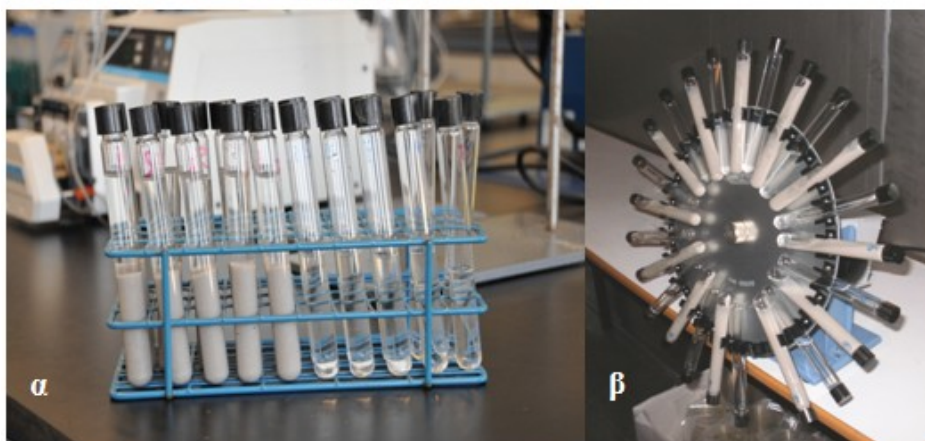
Εικόνα 2.4: Πείραμα λεπτόκοκκης άμμου σε α) στατική και β) δυναμική κατάσταση.
