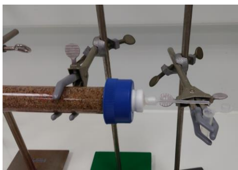
Εικόνα 2.4: Στιγμιότυπο κατά την συλλογή δείγματος, σε φιαλίδιο erpendorf, στην έξοδο της στήλης.
