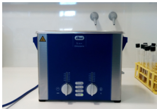
Εικόνα 8.3.2: Λουτρό υπερήχων που χρησιμοποιήθηκε για την σταθεροποίηση της θερμοκρασίας των δειγμάτων κατά την προετοιμασία για ανάλυση με φασματοφωτόμετρο.
