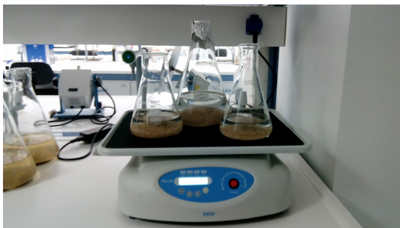
Εικόνα 6.1.5.1: Ανάδευση άμμου κατά την διαδικασία καθαρισμού.
