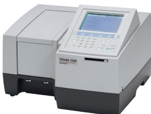
Εικόνα 7.1.1: Φασματοφωτόμετρο ορατού που χρησιμοποιήθηκε για την μέτρηση των δειγμάτων.
