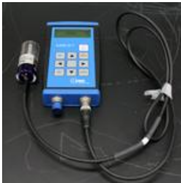
Εικόνα 4.9: Πιεσόμετρο χειρός για την μέτρηση της πίεσης στο δοχείο κενού
