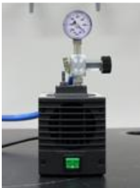
Εικόνα 4.6: Αντλία κενού , η οποία φέρει ρυθμιστή πίεσης.
