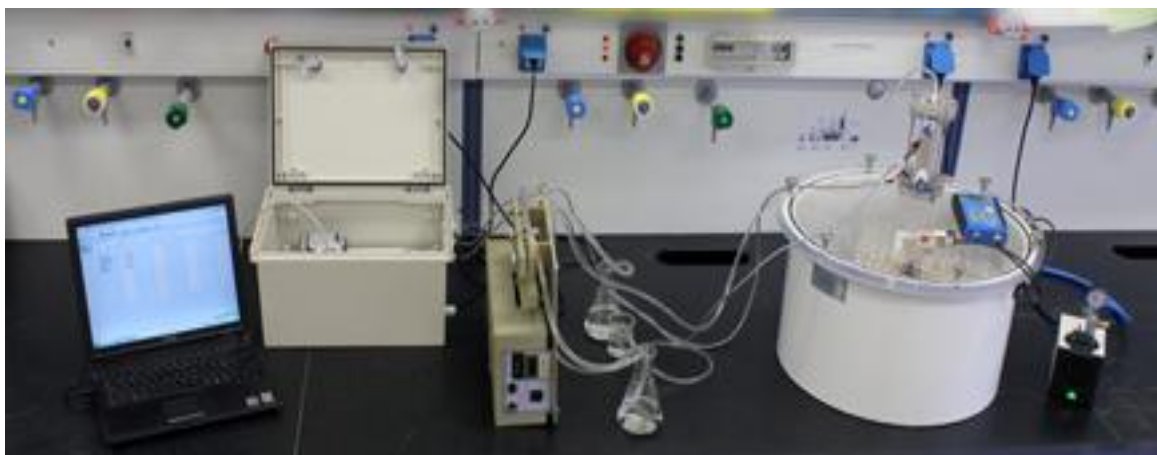
Εικόνα 4.1 Φωτογραφία της πειραματικής διάταξης για τη μελέτη της μεταφοράς πειραμάτων υπό ακόρεστες συνθήκες.
