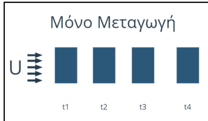
Σχήμα 7: Εδώ παρατηρούμε το φαινόμενο της μεταγωγής. Ο ρύπος κινείται εμβολικά εντός του μέσου και δεν μεταβάλλεται το σχήμα του πλουμίου με το χρόνο
