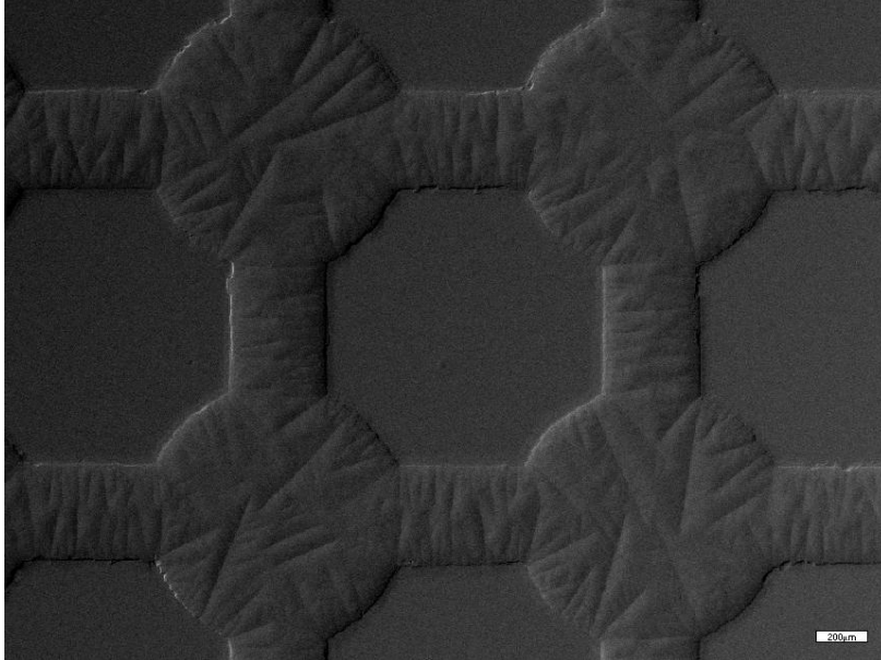
Εικόνα Π.Α.1: Τοπογραφική αποτύπωση του δικτύου πόρων με μεγέθυνση 33x.
