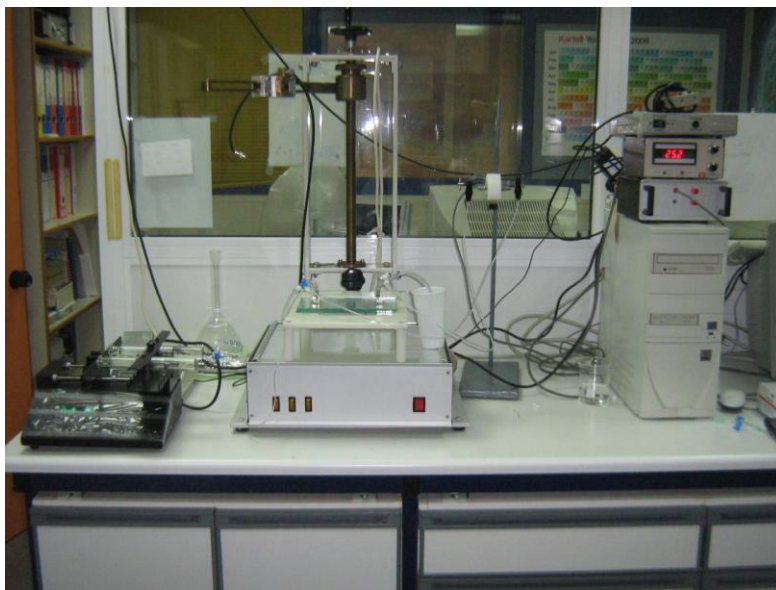
Εικόνα Π.Β.1: Πειραματική διάταξη για τη διεξαγωγή πειραμάτων ροής σε γυάλινα δοκίμια.
