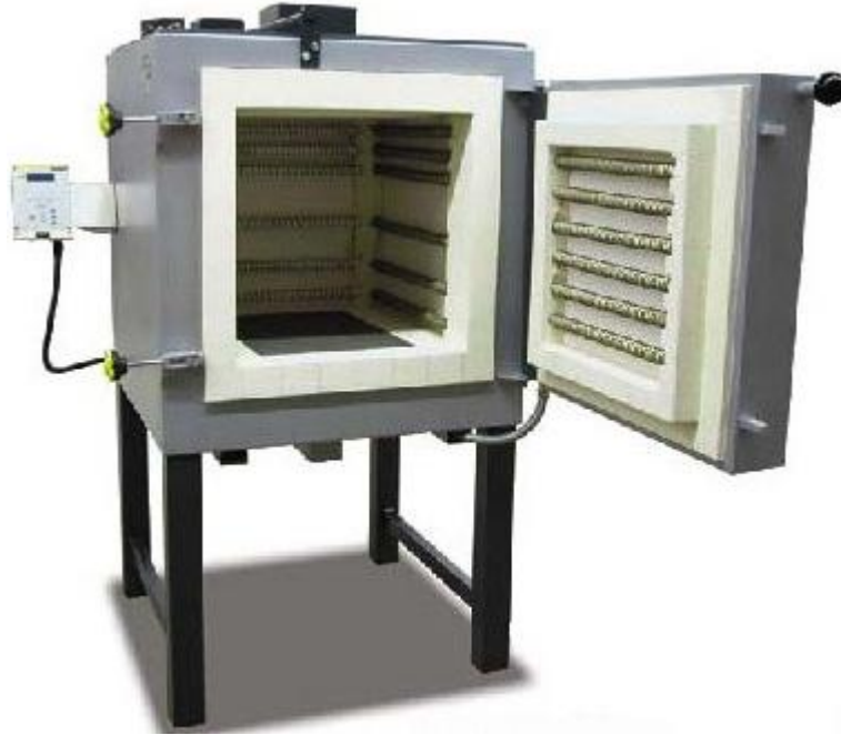
Εικόνα 3.9: Φωτογραφία του φούρνου Nabertherm που χρησιμοποιήθηκε για την πυροσυσσώματωση των γυάλινων δοκιμίων.
